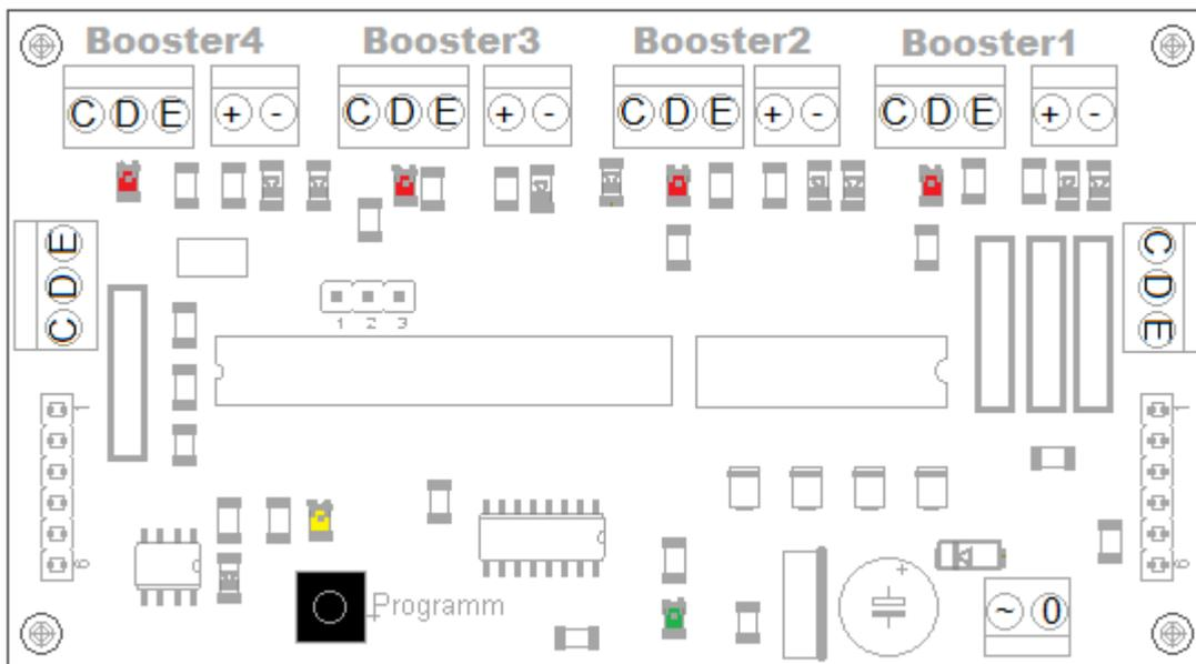
Die s88-Anschlussstecker sind so platziert, das Standartkabel nach außen weg zeigen müssen. Die jeweilige Gleisspannung der Booster kann beliebig angeschlossen werden, da die Eingänge über Optokoppler getrennt sind.
