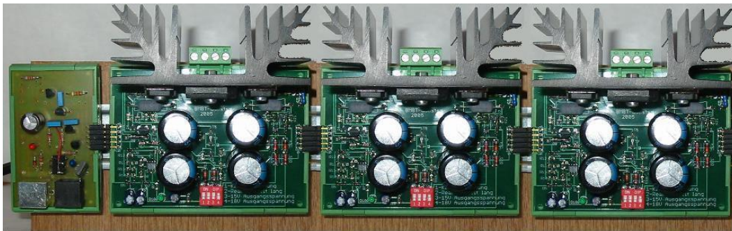
3x B5 + 1xMSA (Mobile-Station-Adapter) auf Hutprofilschiene
