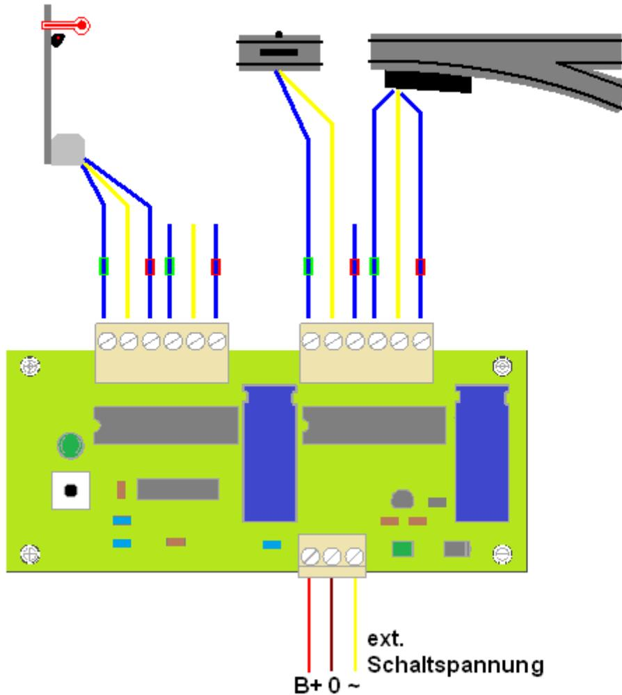
Hier ist beispielhaft die Variante mit externer Hilfsspannung dargestellt. Soll die Schaltenergie der Digitalspannung entnommen werden, so sind, wie bei der Programmierung, die 1. und 3. Klemme zu brücken.
